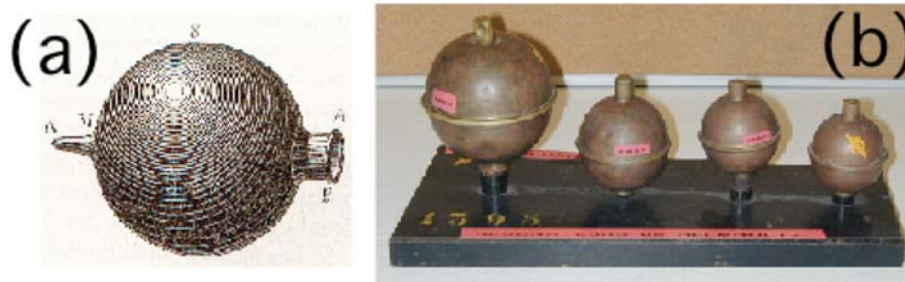
FIG. 4 – Les systèmes “antiques” de résonateur de Helmholtz sont formés d'une cavité sphérique S, présentant une ouverture AB, et, à l'opposé de cette ouverture, un petit appendice creux MN que l'on introduit dans l'oreille (a). Pour analyser un son, on se place de manière à bien l'entendre et on détermine, en plaçant successivement dans l'oreille les divers résonateurs ( cf. (b)), quels sont ceux qui donnent la sensation d'un renforcement considérable.
