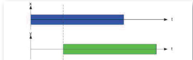
Figure 17 - Le signal amplifié par l'aide auditive (vert) est en retard par rapport au signal émis (bleu).
